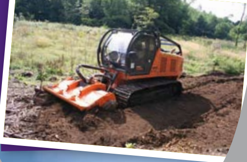
2 Broyage des souches et préparation du terrain (hersage, passage au rouleau...)
